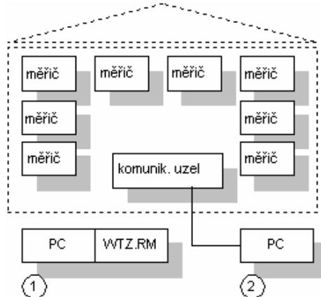
2. Přímý odečet do PC. Zde je možné vyčítat komunikační uzel přes M-Bus výstup, s použitím odečtového software ACT26 a M-Bus MiniMasteru WZF-MBM s PC adaptérem WZF.STPC. Nebo je možné použít komunikační uzel WT\*16.232 (s rozhraním RS-232) pro přímé připojení PC prosřednictvím RS232 kabelu WTZ.K232.
