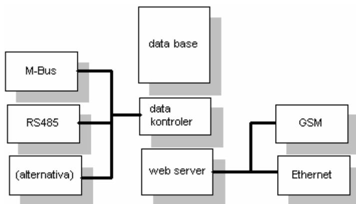
Brána má vstup pro M-Bus, který je možné využít jak k připojení sítí po sběrnici M-Bus, ale také pro jednoduchou a přímou integraci dalších měřiců využívající sběrnici M-Bus. V současnosti brána umožňuje uložení aktuálních údajů o spotřebě, t.j. údaje o spotřebě k danému dni a měsíční hodnoty až pro 2 000 měřiců. Brána umožňuje komunikaci mimo objekt (dálkový odečet) prostřednictvím různých typů komunikace (GSM nebo Ethernet).
