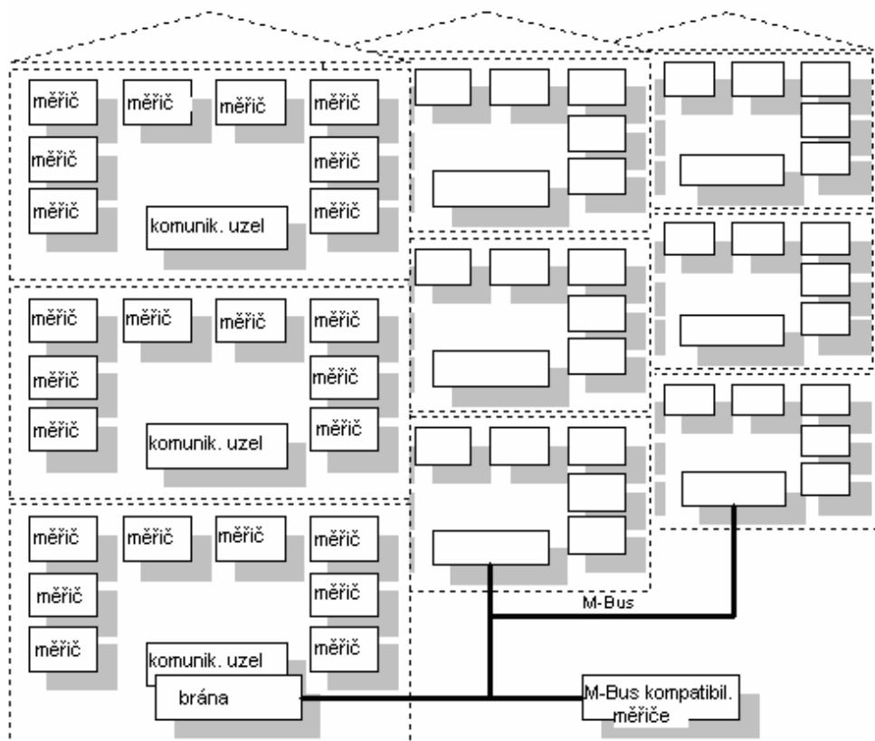
Propojení přes M-Bus nabízí mnoho možností pro následné rozšíření. Například integrace dalších měřiců na sběrnici M-bus. Použitím standardních M-Bus komponentů může být vytvořena téměř jakákoli velikost sítě.
